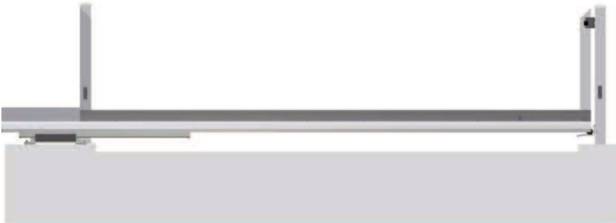
Fundament durchgehend, Durchfahrtbreite abgesetzt (z.B. für Pflasterung)
