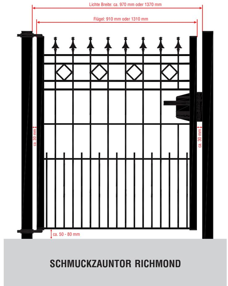
Prüfen Sie vor der Montage der Torpfosten die Aufhängenhöhe Ihrer Flügel. Empfohlen wird ein Abstand von 50 - 80 mm zwischen Flügelunterkante und dem Boden. Berücksichtigen Sie hierzu unbedingt den gesamten Schwenkbereich der Flügel (Unebenheiten im Gelände).
