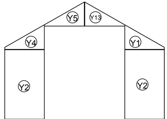
Montieren Sie die Verglasung und Aluminiumprofile in der oben gezeigten Reihenfolge. Klopfen Sie diese Abdeckprofile mit einem Gummihammer in die Kanäle der einzelnen Hauptprofile, einschließlich L11A & B & D & E und L12C & D & F & G. Bringen Sie die Z01-Schrauben wie auf Seite 52 gezeigt an.
