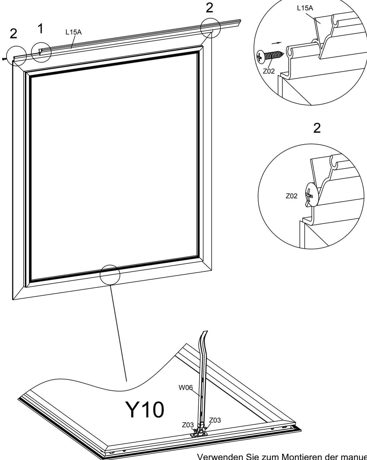
Verwenden Sie zum Montieren der manuellen Öffner W06 und befestigen Sie ihn mit Z03-Schrauben. Automatischen Öffnern können montiert werden, sobald das Gewächshaus fertig zusammengebaut ist.
