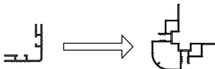
2. Eine große Verbesserung für dieses neue Gewächshaus ist die Leistenabdeckung, die eine sauberere und stärkere Möglichkeit darstellt, die Verglasung zu befestigen. Ein weiterer Vorteil ist, dass diese Gewächshäuser mit Glas oder Polycarbonat unterschiedlicher Dicke verglast werden können.
