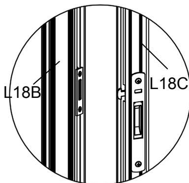
Stellen Sie den W20-Einsteller zum Schluss so ein, dass er nach dem Einbau der gesamten Türrahmen richtig eingerastet ist, und befestigen Sie ihn dann mit der Schraube S05.
