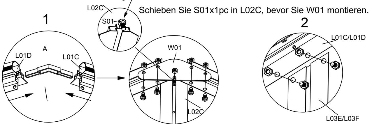
Montieren Sie L01B & D und L01A & C mit Verbinder A und der Halterung W01 und ziehen Sie sie dann mit den mitgelieferten Muttern und Schrauben fest.
