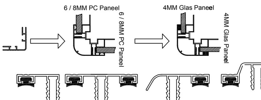
\* Schieben Sie die Gummidichtungen in alle Profile, wenn Sie Glasscheiben einsetzen (NICHT für PC-Scheiben vorgesehen)
