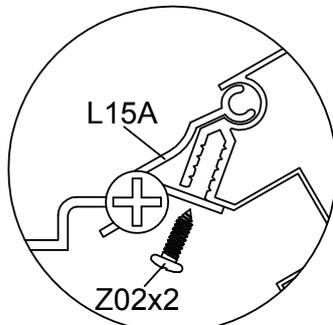
Schieben Sie L15A in die Firstrahmen L06C & D & E und sichern Sie sie mit Z02-Schrauben in der richtigen Position (siehe Abb. Oben).
