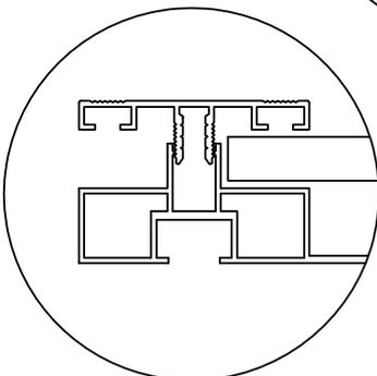
Klopfen Sie alle Profile mit einem Gummihammer wie oben gezeigt in die Kanäle der einzelnen Rahmenprofile, einschließlich L09A & B & C, L11B & F & G und L12B & G & H & I & J & K.
