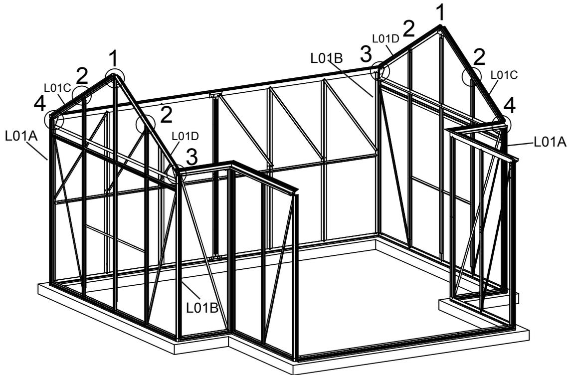
Montieren Sie L01C und L01D mit Verbinder A und der Halterung W01 und ziehen Sie sie mit den mitgelieferten Schrauben und Muttern fest.
