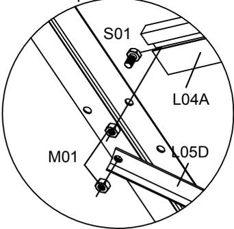
Schieben Sie 2 x S01, um L04A zu montieren, und schieben Sie 2 x S04, um W08 zu montieren.
