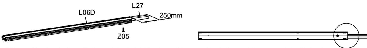
Führen Sie den halben Teil von L27 in L06D ein und lassen Sie 250 mm Länge von L27 übrig. Dann L27 und L06D mit Z05 sichern.
