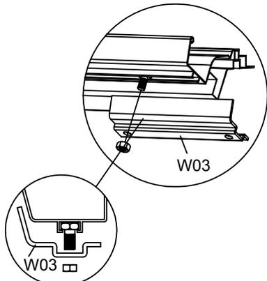
Montieren Sie L07A x 2 bis W03 und W04 und ziehen Sie sie dann mit Schrauben und Muttern fest.
