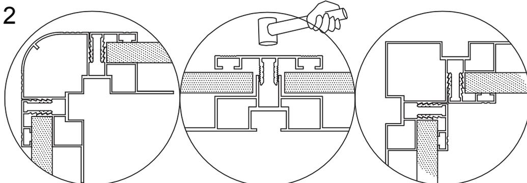
Schieben Sie alle Y6-Wandpaneele in Position. Die Oberseite der Wandpaneele sollte hinter das Rinnenprofil geschoben und dann gegen das Grundprofil gedrückt werden (siehe Abb. 3 oben). Montieren Sie L11A & C & H und L12A wie oben gezeigt und klopfen Sie diese Profile mit einem Gummihammer vorsichtig in die Kanäle der einzelnen Rahmenprofile.
