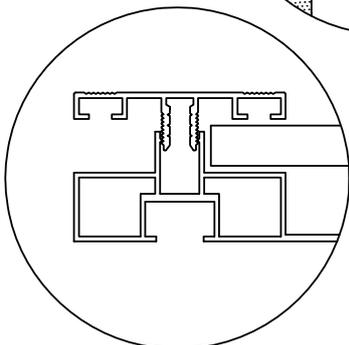
Alle Abdeckprofile wie oben gezeigt mit einem Gummihammer in die Kanäle der einzelnen Rahmenprofile einschlagen, einschließlich L09D & E, L11B & F & G and L12A & G & H & I & J & K.
