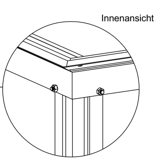
Montieren Sie L07B & C durch die W11-Halterung und ziehen Sie sie dann mit Schrauben und Muttern fest.
