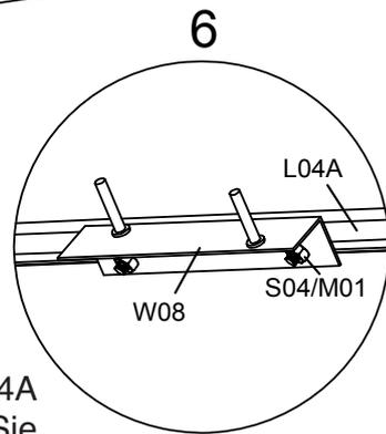
Schieben Sie 2 x S01, um L04A zu montieren, und schieben Sie 2 x S04, um W08 zu montieren.
