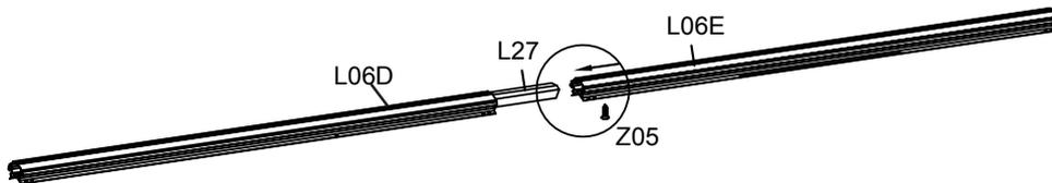
Stecken Sie ein anderes Ende von L27 in L06E und stellen Sie sicher, dass die Verbindung ordnungsgemäß hergestellt ist. Dann sichern Sie sie mit Z05.
