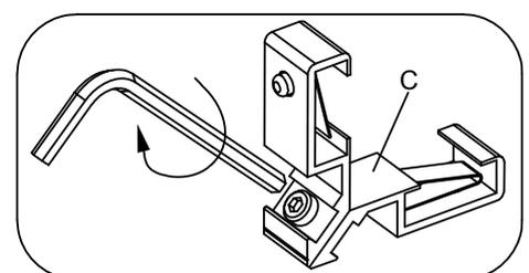
Montieren Sie das PC-Paneel Y11, gefolgt von L21C & D, und schlagen Sie dann vorsichtig mit einem Gummihammer auf die Profile, bis Y11 fest sitzt. Befestigen Sie dann die Kappe mit den Z01-Schrauben.
