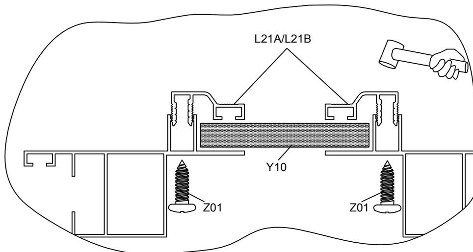
Das PC-Paneel Y10 muss mit der Aluminiumkappe L21A & B abgedeckt werden und dann vorsichtig mit einem Gummihammer gegen die Profile geschlagen werden, bis Y10 fest sitzt.
