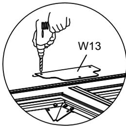
Setzen Sie W13 in die Mitte der Verbindungsstelle von L06C & L06D & L06E und bohren Sie dann die Löcher in W13  $\varnothing$  3,2 mm.
