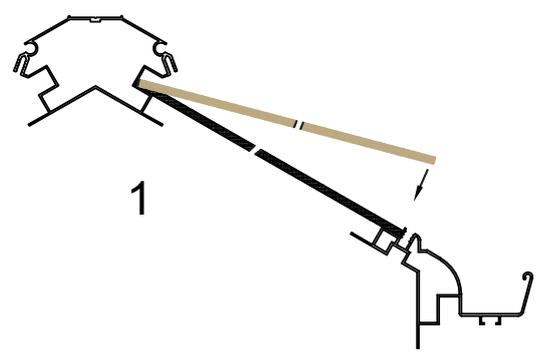
Montieren Sie alle Dachpaneele, indem Sie die Paneele in den First einsetzen und dann auf das Rinnenprofil legen.
