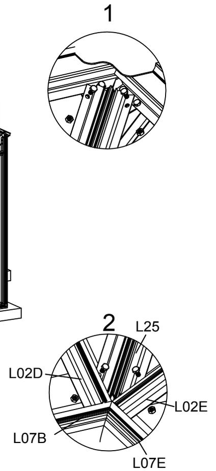
Montieren Sie L02F & L02G und stellen Sie sicher, dass Sie 1 zusätzliche Schraube in den Kanal jedes L02F & L02G schieben, die später zum Befestigen der Strebe L22 benötigt wird.
