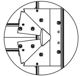
Montieren Sie L06C & L06D & L06E mit der Halterung W12 und ziehen Sie sie dann mit den mitgelieferten Muttern und Schrauben fest.
