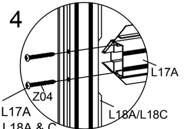
Schrauben Sie L17A mit Z04 an den L18A & C.
