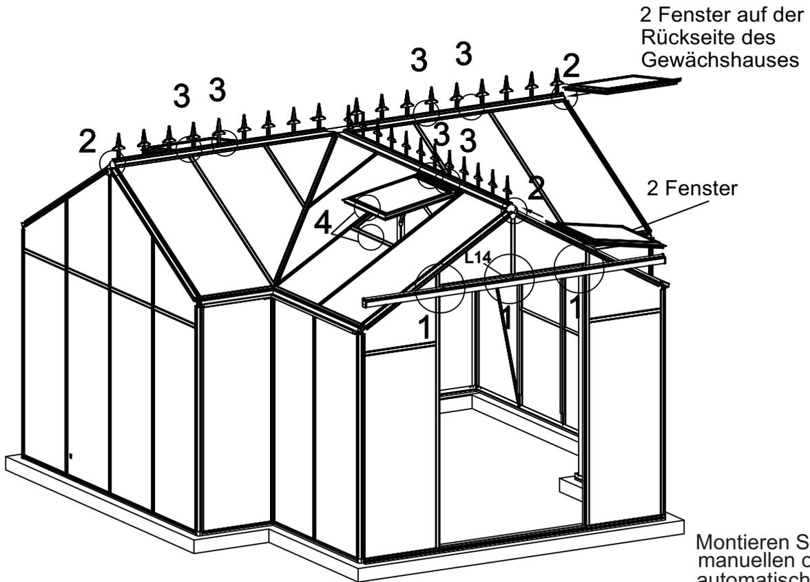
Montieren Sie die manuellen oder automatischen Fensteröffner.
