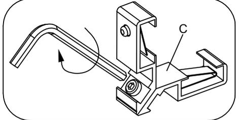
Montieren Sie das PC-Paneel Y11, gefolgt von L21C & D, und schlagen Sie dann vorsichtig mit einem Gummihammer auf die Profile, bis Y11 fest sitzt. Befestigen Sie dann die Kappe mit den Z01-Schrauben.
