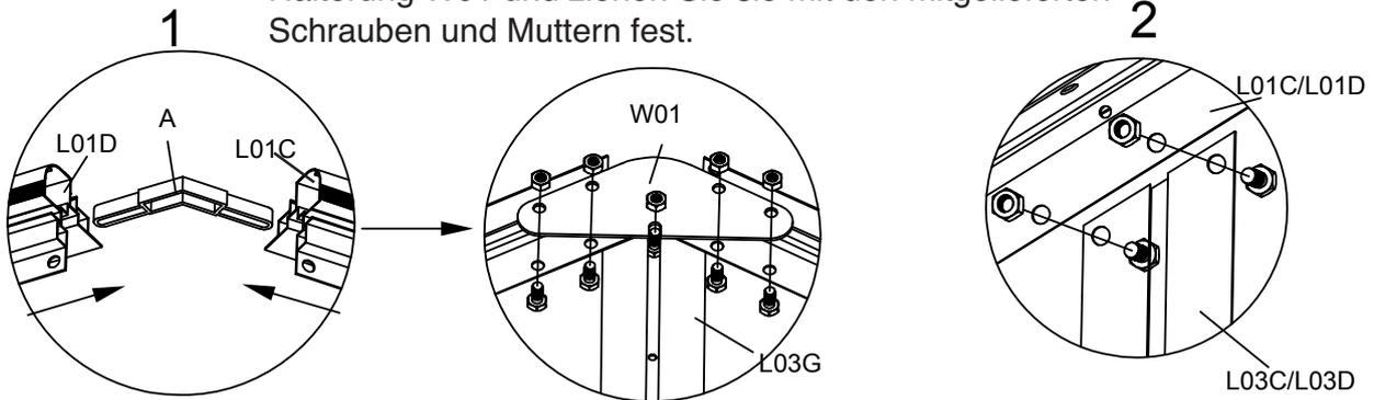
Montieren Sie L01B & D und L01A & C mit Verbinder A und der Halterung W01 und ziehen Sie sie dann mit den mitgelieferten Muttern und Schrauben fest.
