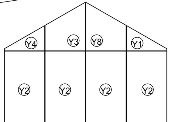
Montieren Sie die Verglasung und Aluminiumprofile in der oben gezeigten Reihenfolge. Klopfen Sie diese Abdeckprofile mit einem Gummihammer in die Kanäle der einzelnen Hauptprofile, einschließlich L11A & B & C und L12C & D & E & G. **WIEDERHOLEN SIE DIE GLEICHE MONTAGE FÜR DIE ANDERE SEITE.** Bringen Sie die Z01-Schrauben wie auf Seite 52 gezeigt an.
