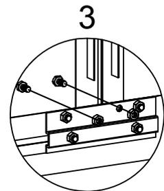
Montieren Sie alle L05C- und L22B-Streben wie abgebildet.
