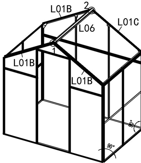
Montieren Sie L06 auf jedem L01B & L01C mit dem zusätzlichen S03, das zuvor eingeschoben wurde. \* Stellen Sie sicher, dass nach der Installation von L06 noch 1 x S03 in den Kanälen jedes L01 verbleibt, was für die spätere Montage von L12A auf dem Dach vorgesehen ist.
