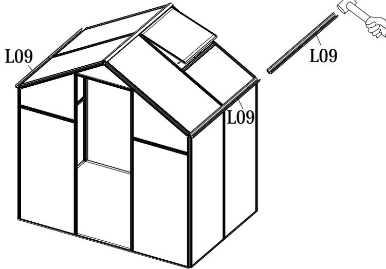
Schieben Sie jedes L09 wie gezeigt in die Nut jedes L07, sobald alle Paneele vollständig eingesetzt sind. Verwenden Sie bei Bedarf einen Gummihammer.
