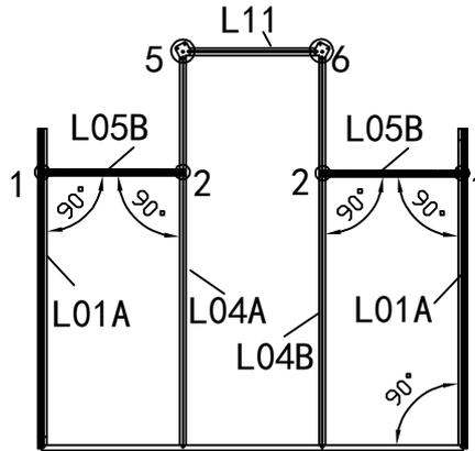
1. Montieren Sie jeden L05B auf jedem L01A & L04A & L04B unter Verwendung von Z08 mit dem Akkuschrauber. Stellen Sie sicher, dass sich L05B im rechten Winkel befindet.
