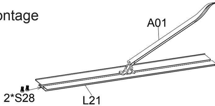
Schieben Sie 2 x S28-Schrauben in den Kanal von L21 und installieren Sie den Entlüftungsarm A01 in der Mitte mit S28 & M02.
