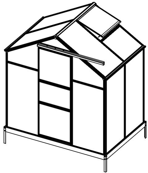
Montieren Sie 2 x L08A, L10 & L13 auf die Unterkonstruktion A1 & B1 mittels Z08 mit dem Akkuschauber. Markieren Sie den Abstand zwischn Z08, 238 mm, mit einem Stift.
