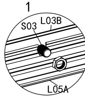
1. Schieben Sie 2 x S03 in die Kanäle jedes L03B, um L05A wie in Abbildung 1 zu verschrauben.
