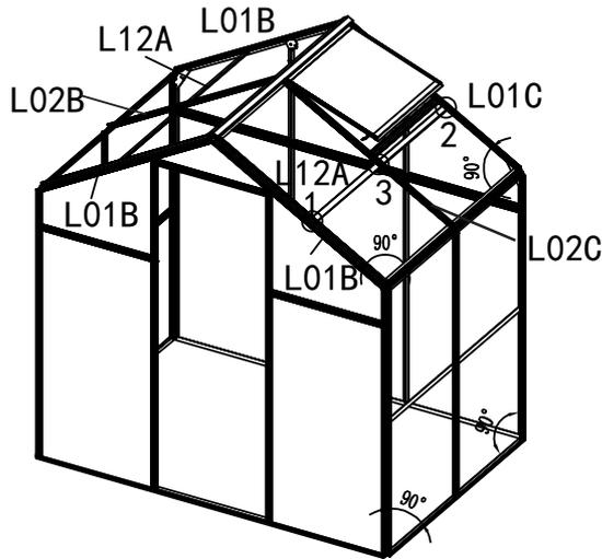
Montieren Sie 2 x L12A auf jedem L01B & L01C in einer Höhe von 421 mm mit dem zusätzlichen S03, das vorher eingeschoben wurde.
