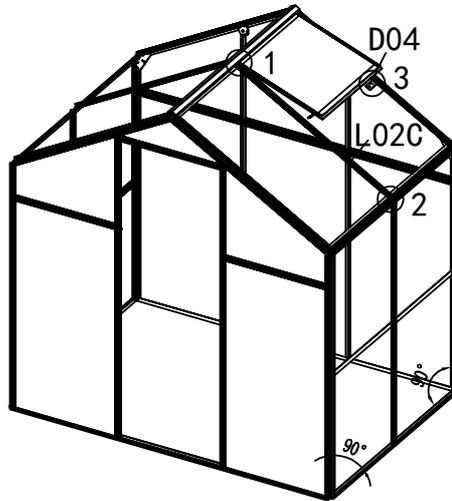
Montieren Sie die letzten Dachprofile L02C mit Z08 mit dem Akkuschauber, sobald die Dachfenster platziert sind.
