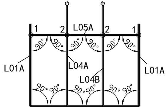
1. Montieren Sie L05A auf jedem L01A & L04A & L04B unter Verwendung von Z08 mit dem Akkuschauber. Stellen Sie sicher, dass L05A im rechten Winkel montiert wird.
