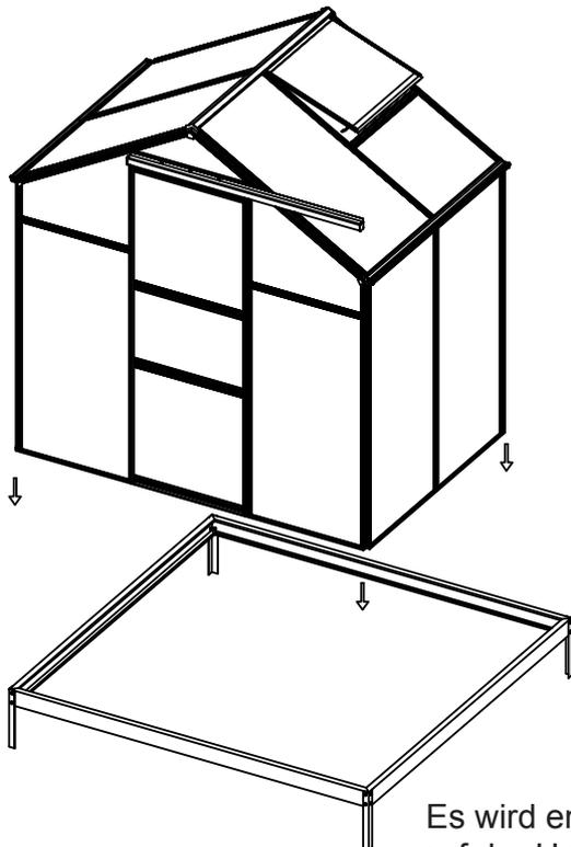
Es wird empfohlen, das Gewächshaus auf der Unterkonstruktion zu befestigen. Am besten machen Sie dies am Ende, wenn das Gewächshaus vollständig zusammengebaut ist.
