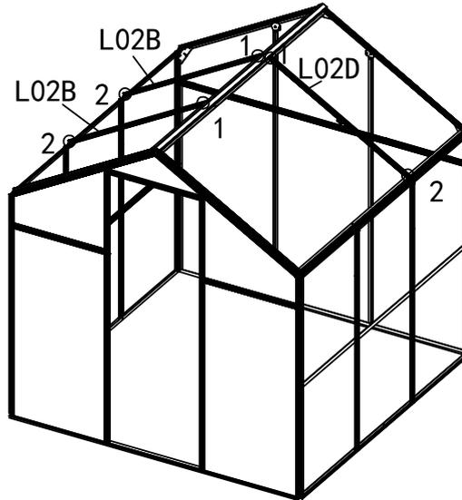
Montieren Sie 2 x L02B & L02D mit Z08 mit dem Akkuschauber auf L06 und L07.
