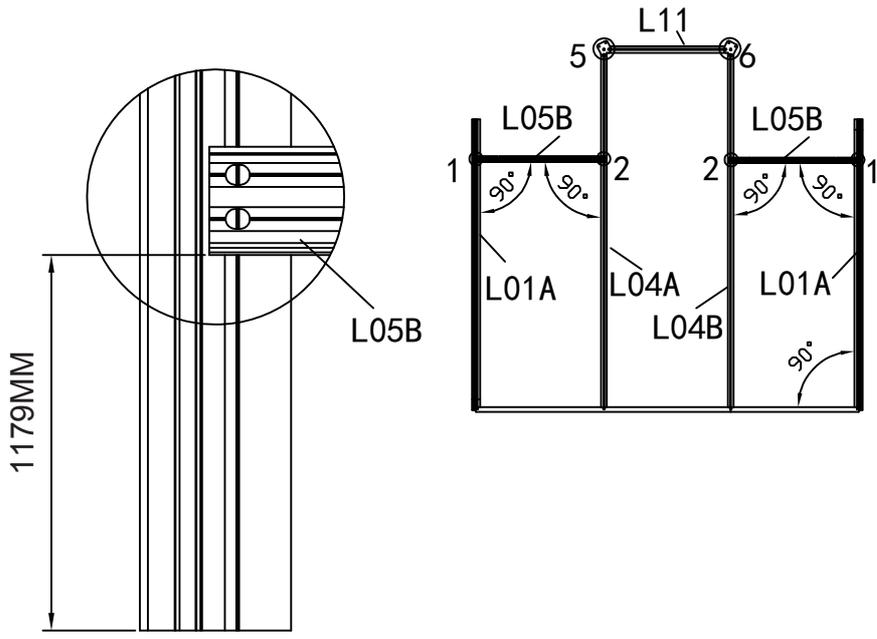
1. Montieren Sie jeden L05B auf jedem L01A & L04A & L04B unter Verwendung von Z08 mit dem Akkuschauber. Stellen Sie sicher, dass sich L05B im rechten Winkel befindet.
