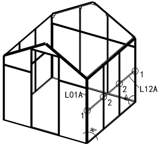
Montieren Sie 2 x L12A auf jedem L01A in einer Höhe von 675 mm mit dem zusätzlichen S03, das zuvor eingeschoben wurde. Montieren Sie dann den Restteil von L12A mit Z08 mit dem Akkuschauber auf jedem L02A.
