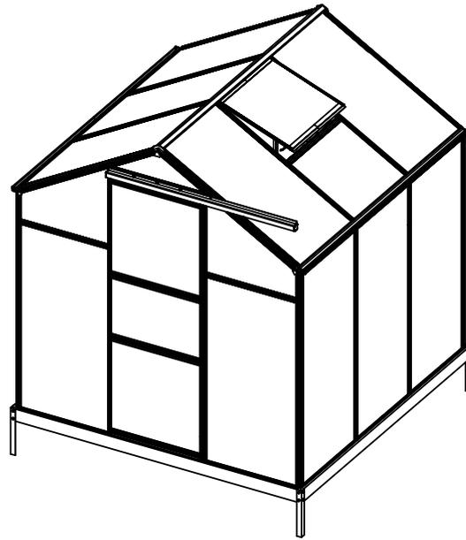
Montieren Sie 2 x L08A, L10 & L13 auf die Unterkonstruktion A1 & B1 mittels Z08 mit dem Akkuschrauber. Markieren Sie den Abstand zwischn Z08, 238 mm, mit einem Stift.
