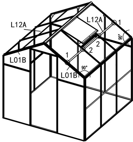
Montieren Sie 2 x L12A auf jedem L01B in einer Höhe von 421 mm mit dem zusätzlichen S03, das vorher eingeschoben wurde.
