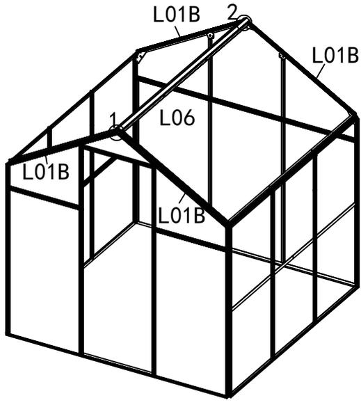
Montieren Sie L06 auf jedem L01B mit dem zusätzlichen S03, das zuvor eingeschoben wurde.
