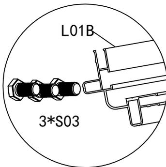
Schieben Sie 3 x S03 in die Kanäle jedes L01B. Verwenden Sie dann eine der Schrauben, um jeden L01B & L07 zu sichern (eine weitere Schraube ist für die spätere Montage von L12A und eine weitere 1 für L06).
