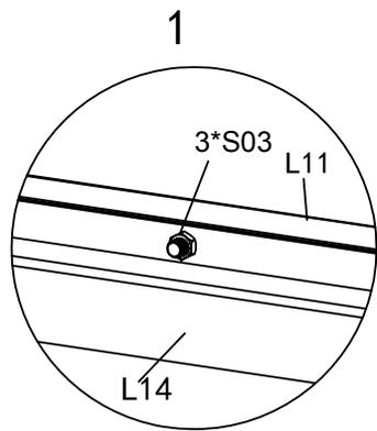
Schrauben Sie L14 mit den zusätzlichen 3 x S03, die zuvor hineingeschoben wurden, auf L11.
