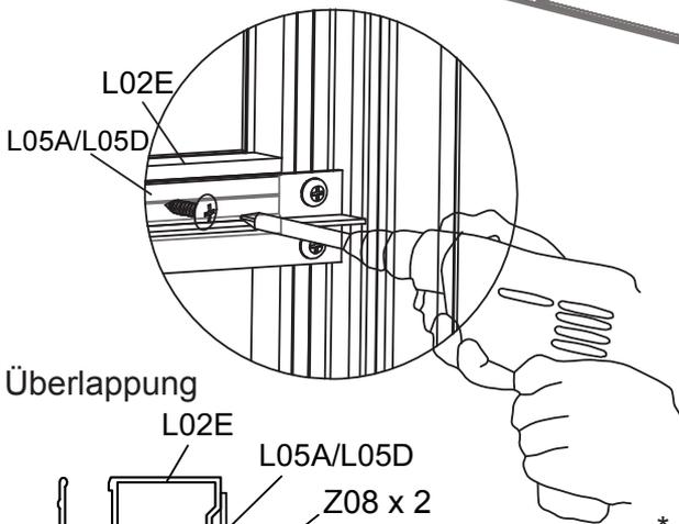
Führen Sie das andere Ende jedes Y5 in den Kanal jedes L02E ein. Montieren Sie jeden L02E mit jedem L05A & L05D mittels selbstschneidenden Schrauben Z08 mit dem Akkuschauber
