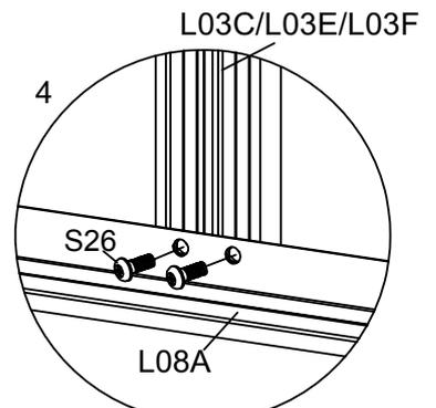
Montieren Sie ein Ende von L20A & L20B und L03C & L03E & L03F mit S26 wie gezeigt auf L08A.
