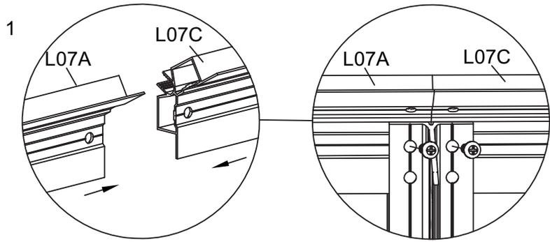
Montieren Sie L07A & L07C mit S26 auf L30A.
