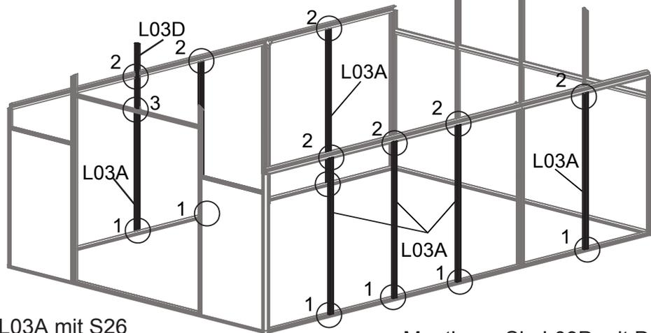
Montieren Sie jeden L03A mit S26 auf L08A & L08C und L07A & L07C.
