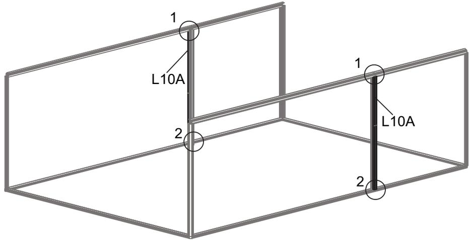
Montieren Sie jedes Ende von L10A mit S26 über L30A auf L07A & L07C und L08A & L08C.
