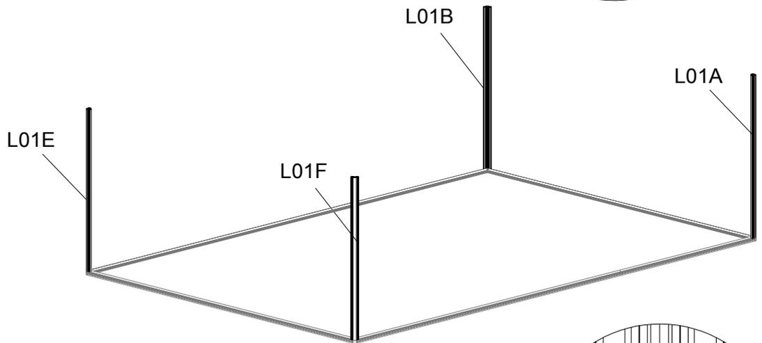
Montieren Sie L01A & L01B & L01E & L01F auf L08A & L08C und befestigen Sie sie mit S26.
