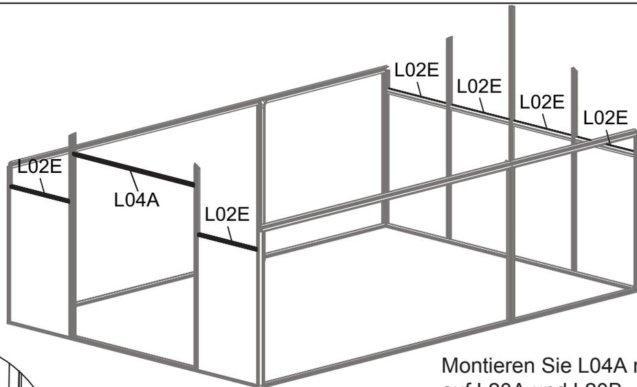
Montieren Sie L04A mit S26 auf L20A und L20B.
