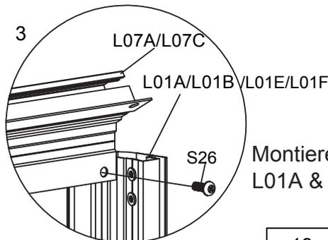
Montieren Sie L07A & L07C mit S26 auf L01A & L01B & L01E & L01F.
