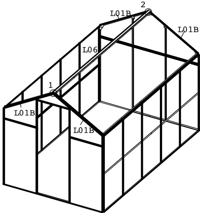
Montieren Sie L06 auf jedem L01B mit dem zusätzlichen S03, das zuvor eingeschoben wurde.
