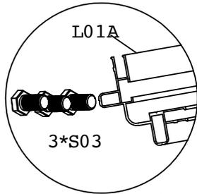
Schieben Sie 3 x S03 in die Kanäle jedes L01A. Verwenden Sie dann 2 Schrauben, um jeden L07 & L01A und jeden L08A & L01A zu sichern (eine weitere Schraube ist für die spätere Montage von L12A vorgesehen).
