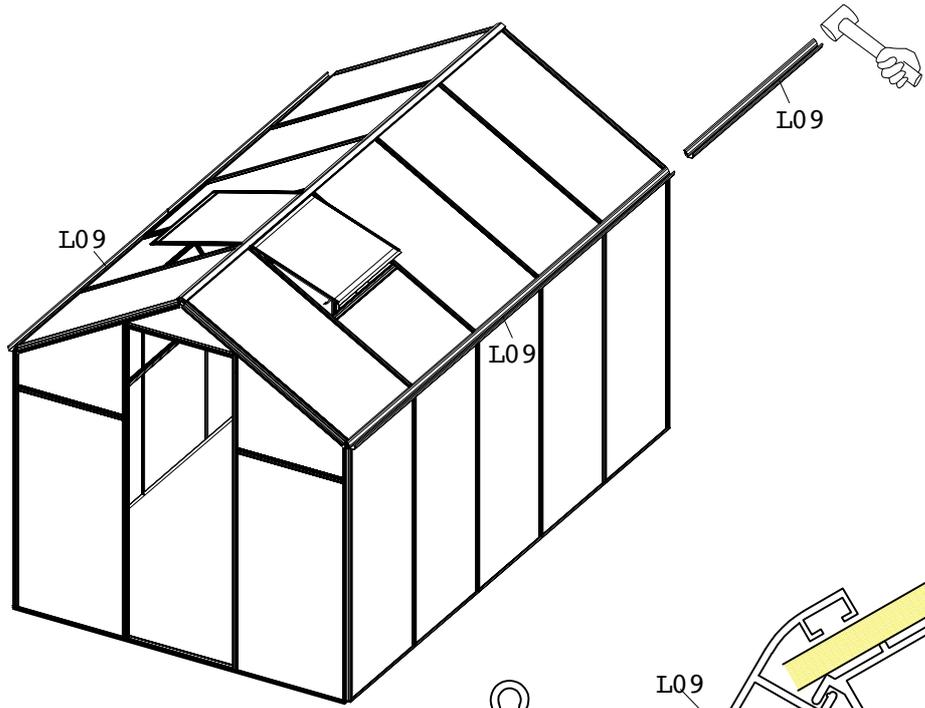
Schieben Sie jedes L09 wie gezeigt in die Nut jedes L07, sobald alle Paneele vollständig eingesetzt sind. Verwenden Sie bei Bedarf einen Gummihammer.
