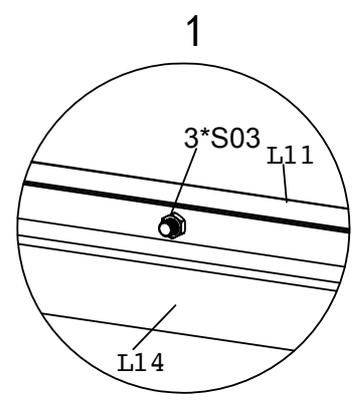
Schrauben Sie L14 mit den zusätzlichen 3 x S03, die zuvor hineingeschoben wurden, auf L11.
