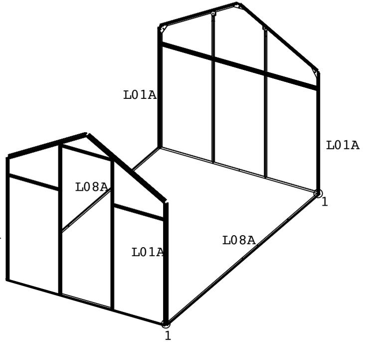
Schieben Sie 3 x S03 in die Kanäle jedes L01B. Verwenden Sie dann eine der Schrauben, um jeden L01B & L07 zu sichern (eine weitere Schraube ist für die spätere Montage von L12A und eine weitere 1 für L06).
