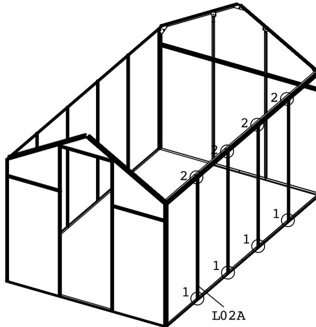
Montieren Sie jeden L02A mit Z08 mit dem Akkuschauber auf jedem L08A und L07.
