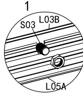
1. Schieben Sie 2 x S03 in die Kanäle jedes L03B, um L05A wie in Abbildung 1 zu verschrauben.
