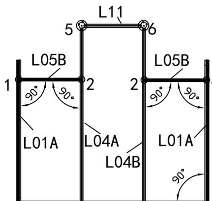
1. Montieren Sie jeden L05B auf jedem L01A & L04A & L04B unter Verwendung von Z08 mit dem Akkuschauber. Stellen Sie sicher, dass sich L05B im rechten Winkel befindet.
