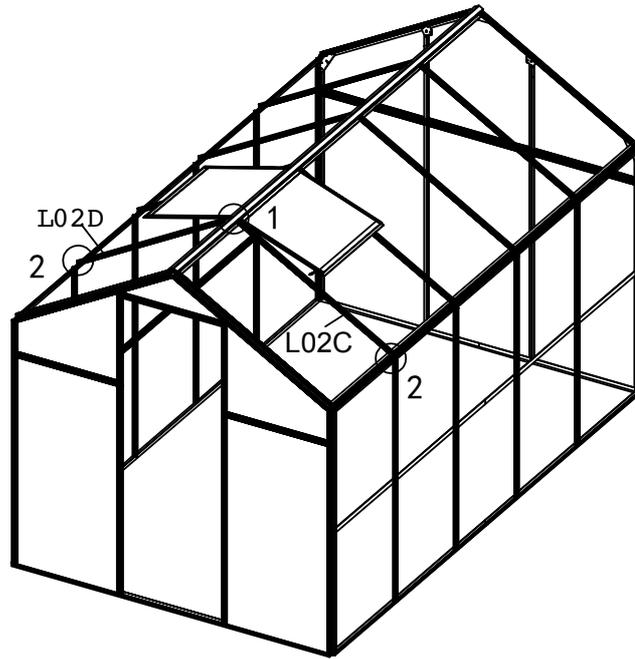
Montieren Sie die letzten Dachprofile L02C und L02D mit Z08 mit dem Akkuschauber, sobald die Dachfenster platziert sind.
