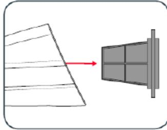
4. Setzen Sie den Filter wieder in den Schmutzbehälter ein und den Schmutzbehälter befestigen Sie indem zuerst die Unterkante auf die Aussparung gesetzt wird und dann die Oberseite hineingeschoben wird, bis sie einrastet.
