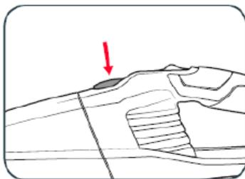
2. Entfernen Sie den Schmutzbehälter, indem Sie die Oberseite des Behälters vom Vakuumgehäuse wegziehen.
