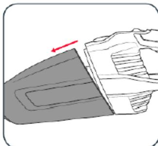
3. Ziehen Sie den Filter aus dem Schmutzbehälter heraus. Entfernen Sie die Rückstände und spülen Sie den Filter mit kaltem Wasser und lassen Sie ihn an der Luft trocknen.
