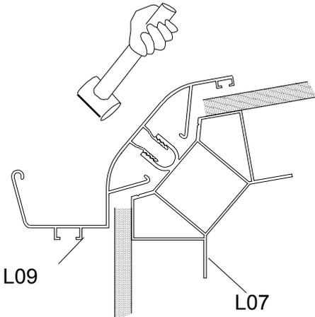
Montieren Sie das Rinnenprofil L09, wenn alle Paneele vollständig eingesetzt sind. Dann L09 mit einem Gummihammer vorsichtig in den Kanal von L07 klopfen.
