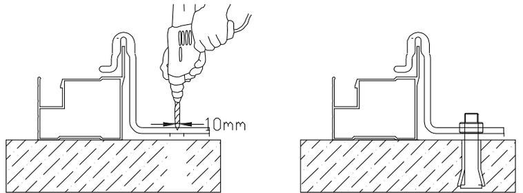
\* Diese Abbildung zeigt die Positionierung der Montagewinkel D07.
