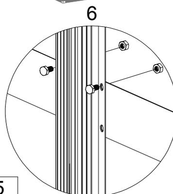
Platzieren Sie ein weitere 2 x L03C wie abgebildet und sichern Sie sie mit S05 & M03 durch die oberen Löcher. Lassen Sie die unteren Löcher für die spätere Montage von L04A & L10. frei.
