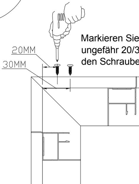
Markieren Sie dann den Abstand von jedem Ende ungefähr 20/30MM. Sichern Sie sie abschließend mit den Schrauben Z08 mit dem Akkuschauber
