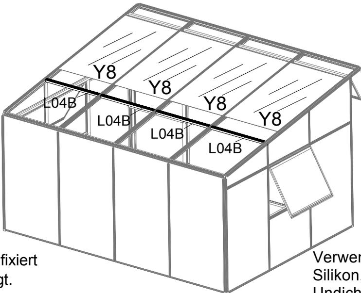
Achten Sie darauf dass die Schnittkante von L04B, die fixiert werden soll, nach oben zeigt.
