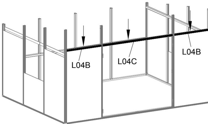
Achten Sie darauf dass die Schnittkante von L04B & C, die fixiert werden soll, nach oben zeigt.
