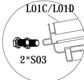
Schieben Sie 3 x S03 in die Kanäle jedes L01A, und 2 x S03 für jedes L01C & L01D. Verwenden Sie dann je eine Schraube, um jedes L07 und L01A zu befestigen und je eine Schraube für L08A & L01A & C & D (die letzte 1 Schraube ist für die spätere Montage von jedem L12A & L06).
