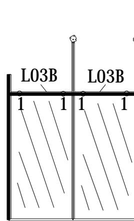
1. Schieben Sie 2 x S03 in die Kanäle jedes L03B, um L05A wie in Abbildung 1 gezeigt zu verschrauben.
