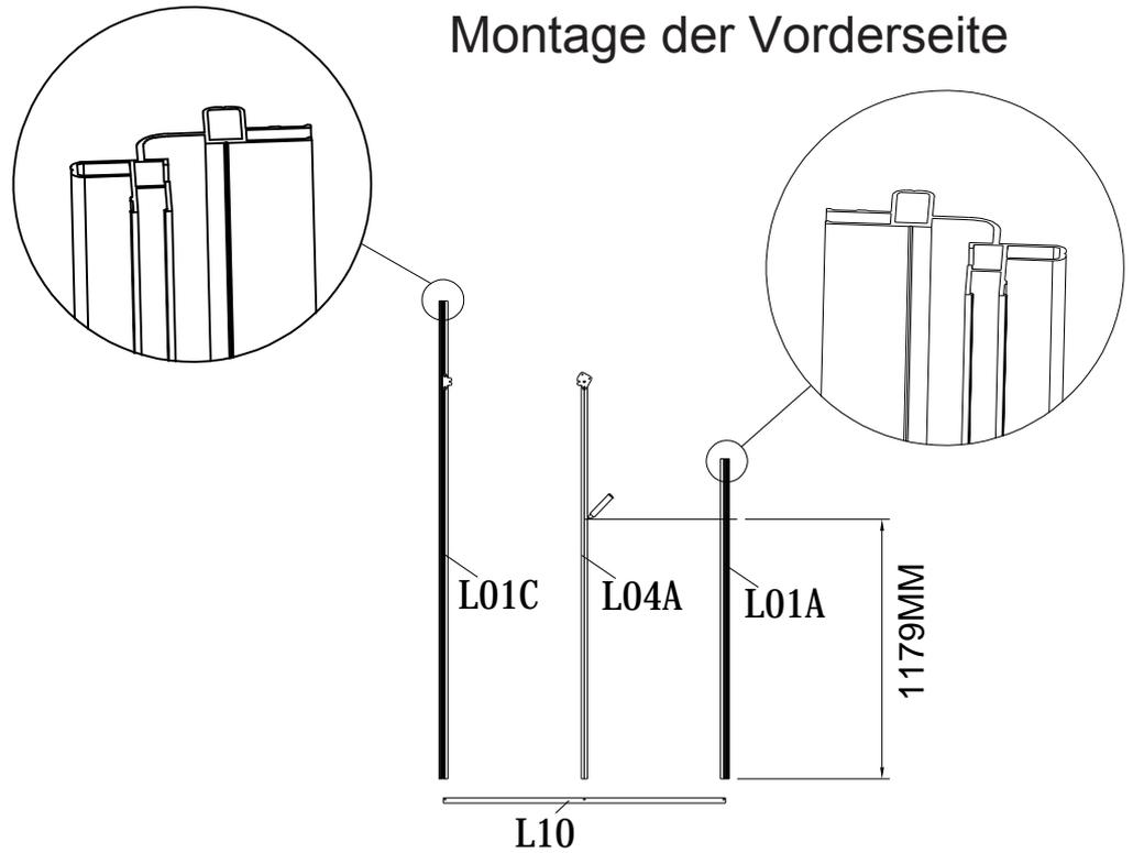
1. Legen Sie die zugehörigen Rahmen L01A & L01C & L04A & L10 aus. Stellen Sie sicher, dass L10 korrekt ausgerichtet ist.
