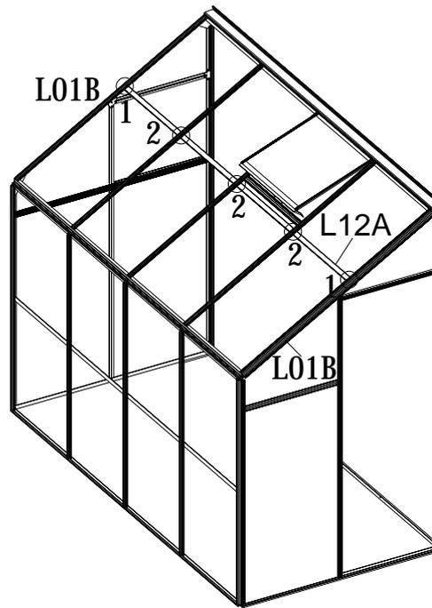
Montieren Sie L12A auf jedem L01B auf einer Höhe von 755MM mit Hilfe von S03 welches zuvor eingeschoben wurde. Montieren Sie dann den Rest von L12A auf L02B & L02C & L02D mit Z08 mit dem Akkuschauber.
