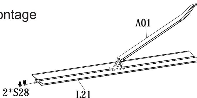
Schieben Sie 2 x S28 (Schrauben) in den Kanal von L21 und montieren Sie den Fensterarm A01 in der Mitte mit S28 & M02.
