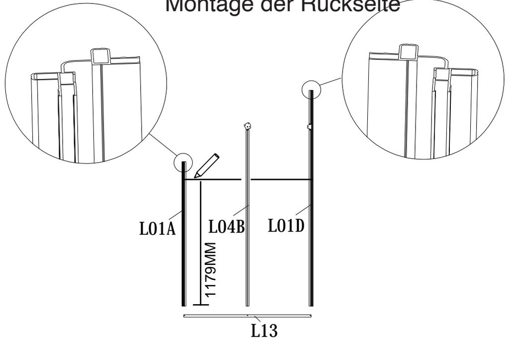
1. Legen Sie die zugehörigen Rahmen, L01A & L01D & L04B & L13 aus. Stellen Sie sicher, dass L13 korrekt ausgerichtet ist.
