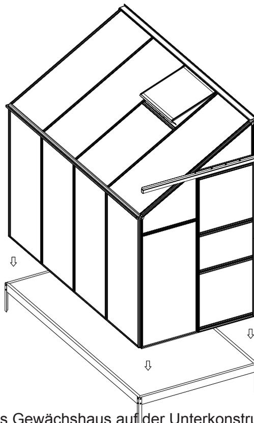
Es wird empfohlen, das Gewächshaus auf der Unterkonstruktion zu befestigen. Am besten machen Sie dies am Ende, wenn das Gewächshaus vollständig zusammengebaut ist.
