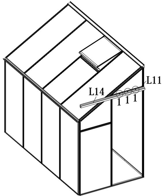
Schrauben Sie L14 auf L11 mit den zusätzlichen 3 x S03, die zuvor eingeschoben wurden.
