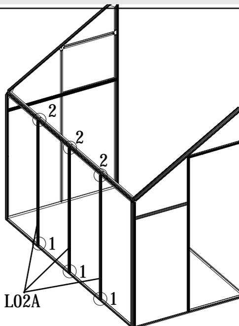
Montieren Sie L02A auf jedem L08A & L07, mit Z08 mit dem Akkuschauber.
