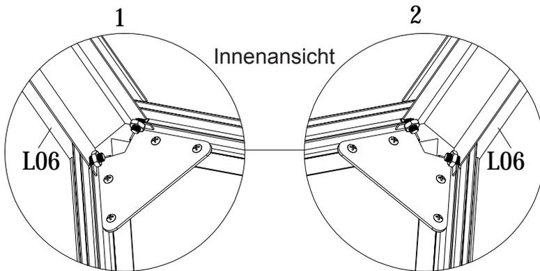
Montieren Sie jedes L02B und L02C auf L06 und L07, indem Sie Z08 mit dem Akkuschauber verwenden.
