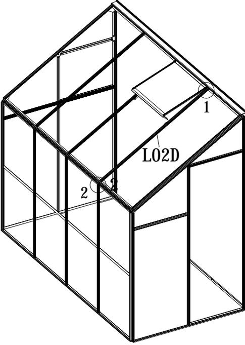
Nach dem Montieren das Dachfenster montieren Sie L02D mit Z08 mit dem Akkuschauber. \*Stellen Sie sicher, dass die Z08-Schrauben in der richtigen Position befestigt sind.
