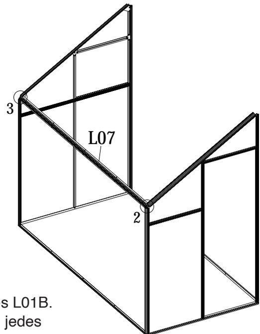
Schieben Sie 3 x S03 in die Kanäle jedes L01B. Verwenden Sie dann eine Schraube, um jedes L01B und L07 zu befestigen (eine weitere Schraube ist für die spätere Montage von L12A und eine weitere für L06) 2
