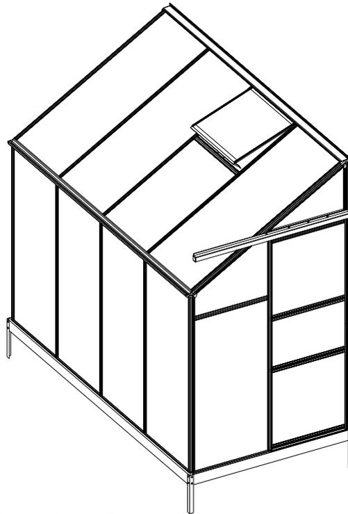
Montieren Sie 2 x L08A, L10 & L13 auf den Grundrahmen A1 & B1 mit den Schrauben Z08 mit dem Akkuschauber. Der Abstand der Schrauben Z08, beträgt 238mm. Machen Sie sich Markierungen mit einem Bleistift. \*Die Schrauben sollten gleichmäßig verteilt sein, um ein sauberes Erscheinungsbild zu gewährleisten.
