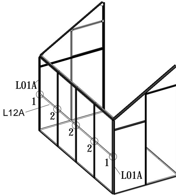
Montieren Sie L12A auf jedem L01A in einer Höhe von 675 mm mit dem zusätzlichen S03, das zuvor eingeschoben wurde. Montieren Sie dann den Rest von L12A auf L02A mit Z08 mit dem Akkuschauber.
