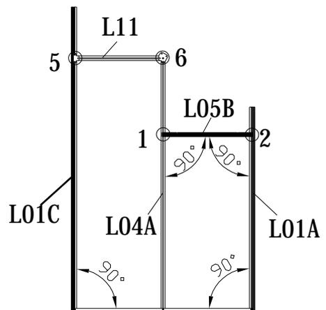
1. Montieren Sie L05B mit den Schrauben Z08 auf jedem L01A & L04A, mit dem Akkuschauber.
