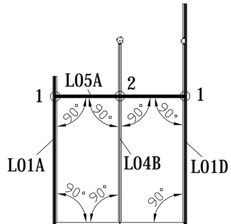
1. Montieren Sie L05A mit den Schrauben Z08 auf jedem L01A & L01D & L04B, mit dem Akkuschauber. Stellen Sie sicher, dass sich L05A im rechten Winkel (90 Grad) befindet.
