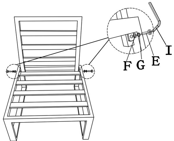
Bitte ziehen Sie die Schraube nicht fest, bis alle Schrauben mit den Löchern ausgerichtet sind.
