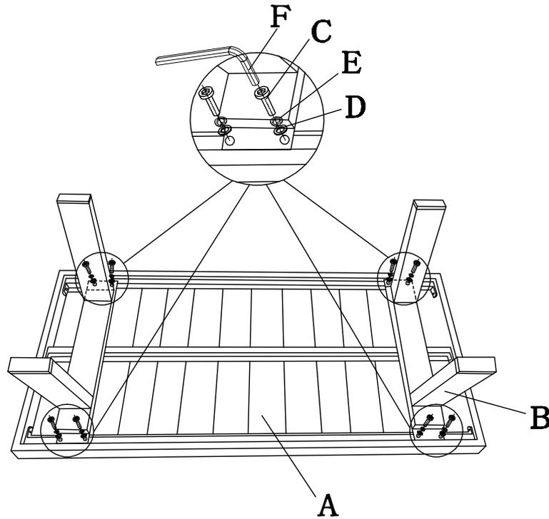
Bitte ziehen Sie die Schrauben nicht fest, bis alle Schrauben mit den Löchern ausgerichtet sind. Versuchen Sie zunächst, alle Schrauben locker anzuziehen, und ziehen Sie dann alle Schrauben ein wenig fester. Ziehen Sie nicht eine Schraube zu fest an, da dies das Anziehen der anderen Schrauben erschweren kann, sondern ziehen Sie am Ende alle Schrauben fest an.
