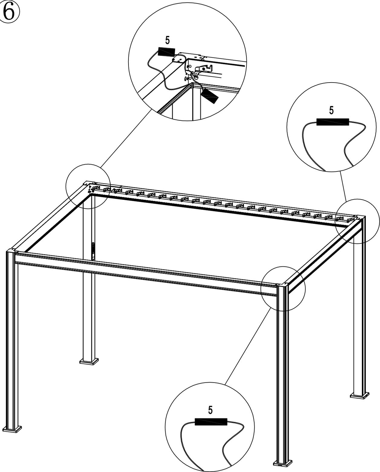
**⚠ Achtung, das Kabel muss innerhalb der Stange positioniert werden, um ein Abschneiden zu vermeiden.
