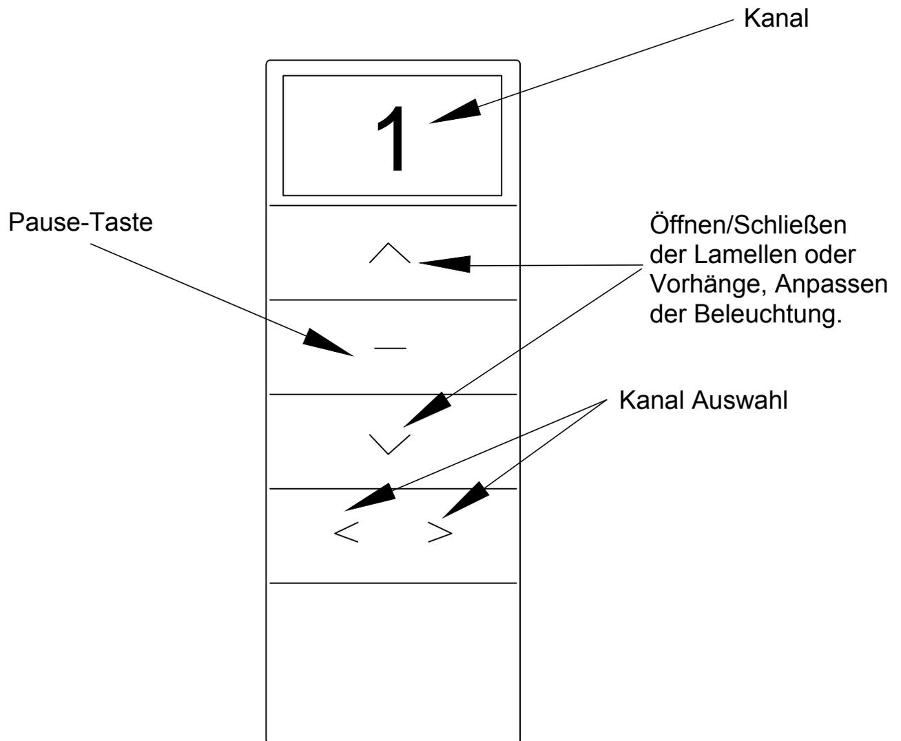
Die Fernbedienung wird mit einer CR-2032-Batterie geliefert. Sie arbeitet mit 433,92 MHz. Ihre maximale Reichweite beträgt je nach Umgebung etwa 40–50 m.
