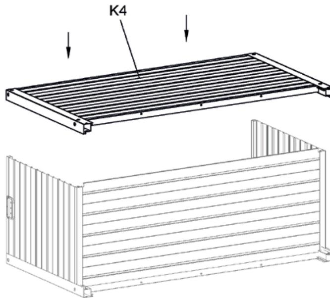
Installieren Sie die Platte K4 mit Z30 an jedem K1, K2 und K5.
