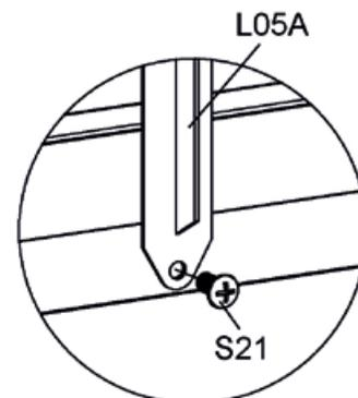
Montieren Sie die Strebe L05A mit S21 darunter.
