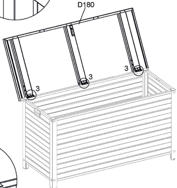
Montieren Sie das obere Panel D180 mit S15 auf das Panel K3.
