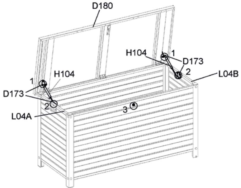
Schrauben Sie die Halterung D173 mit S49 durch D180, K1 und K2.
