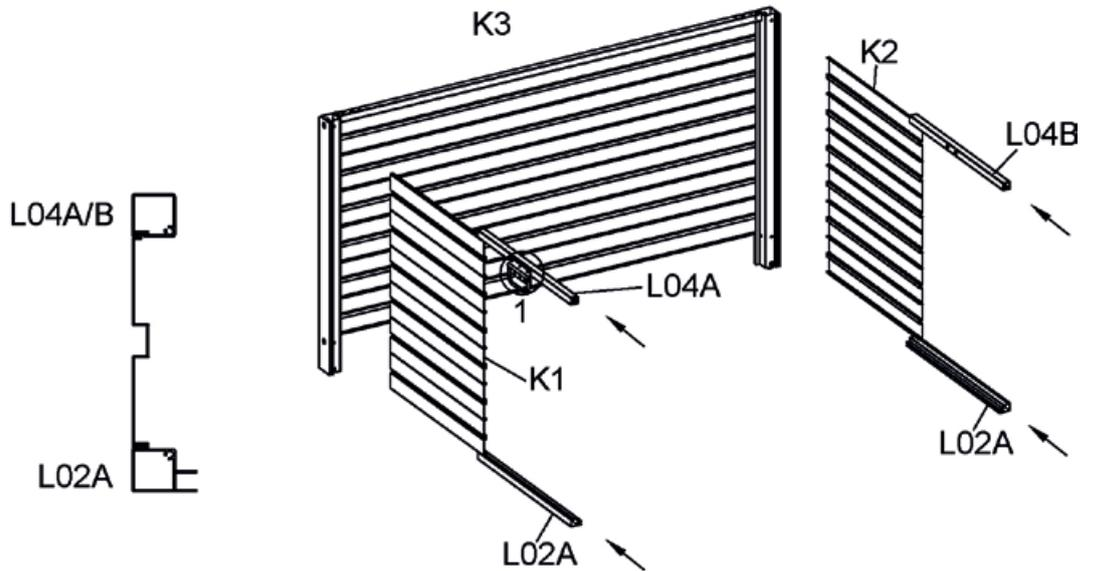
Führen Sie ein Ende jedes Panels K1 und K2 in den Kanal von L02A, L04A und B ein.
