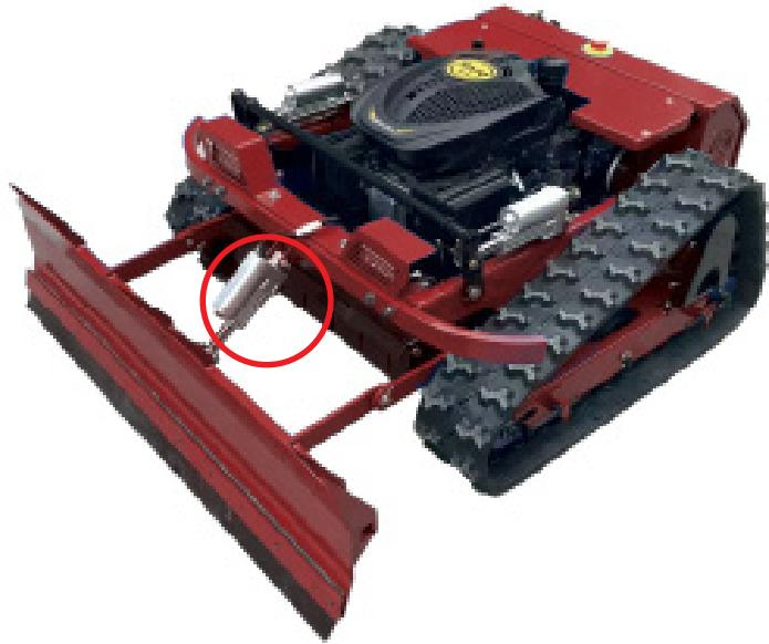
3. Stecken Sie den Stecker des Schneeschaufelmotors in die dafür vorgesehene Steckdose an der Maschine.
