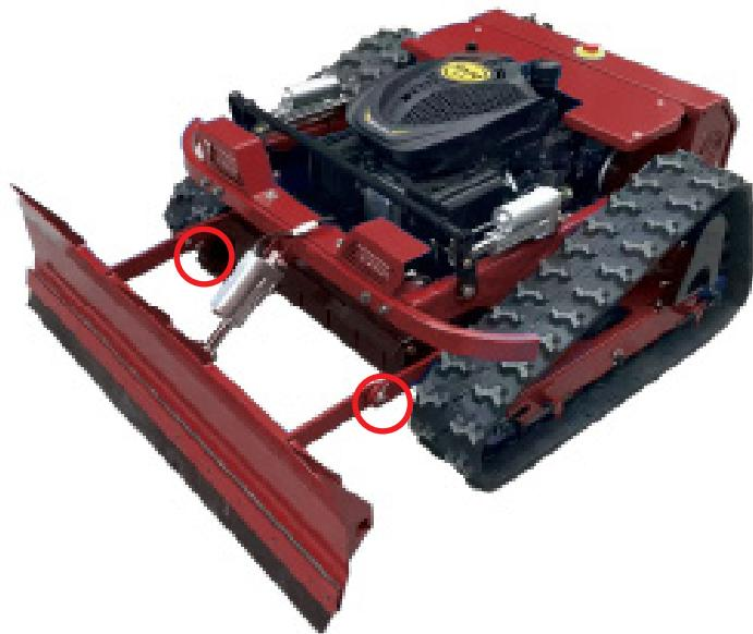
2. Befestigen Sie den Schaufelmotor mit Schrauben in der Mitte der Schaufel und in der Mitte des vorderen Rahmens der Maschine.
