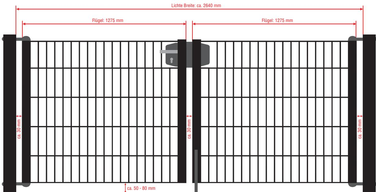
Prüfen Sie vor der Montage der Torpfosten die Aufhängenhöhe Ihrer Flügel. Empfohlen wird ein Abstand von 50 - 80 mm zwischen Flügelunterkante und dem Boden. Berücksichtigen Sie hierzu unbedingt den gesamten Schwenkbereich der Flügel (Unebenheiten im Gelände).
