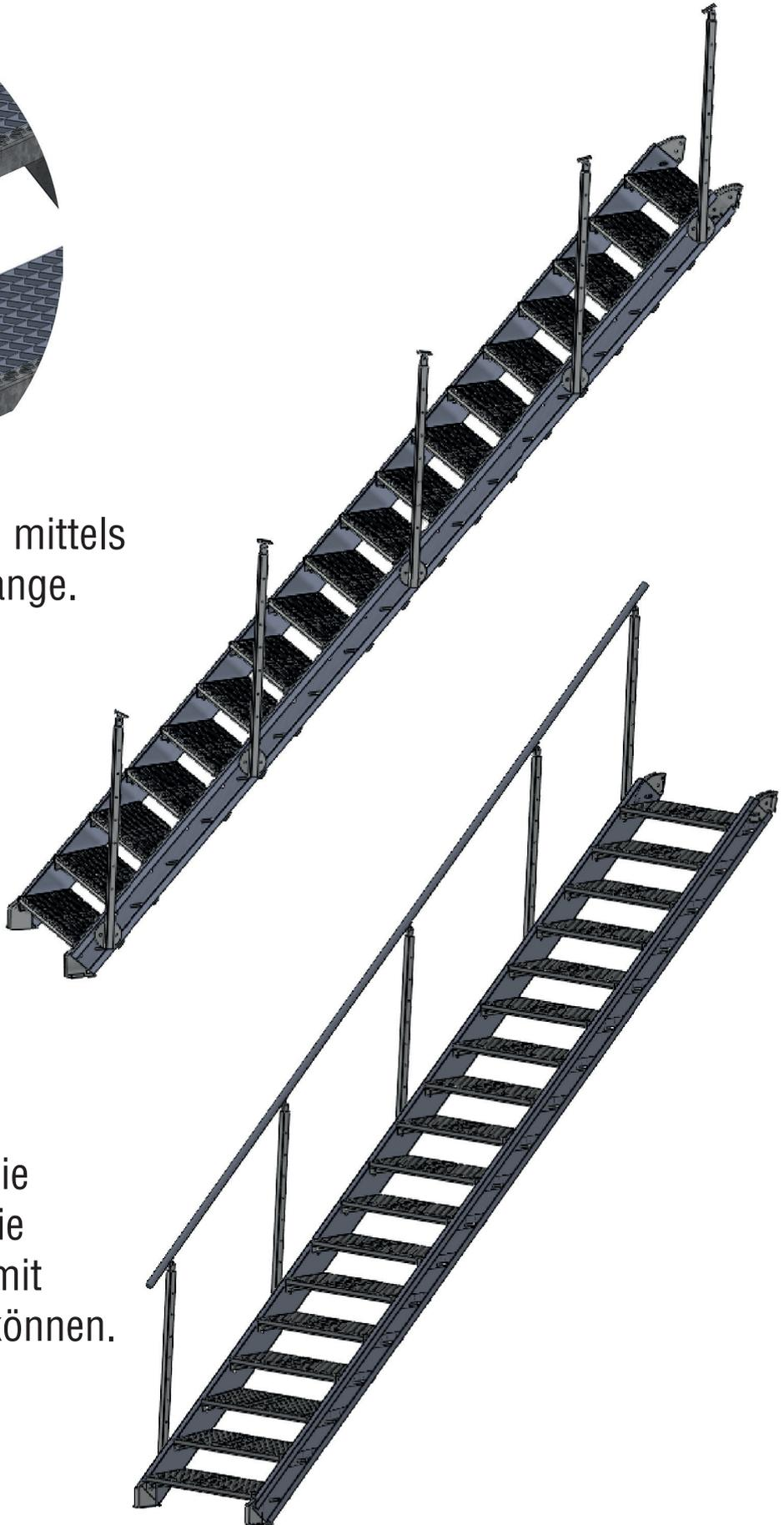
Legen Sie den Handlauf auf die Handlaufträger und bohren Sie an den passenden Stellen damit sie den Handlauf befestigen können.
