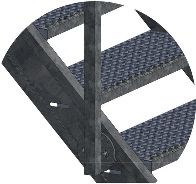
Verschrauben Sie die Pfosten mittels Gegenplatte mit der Stufenwange.
