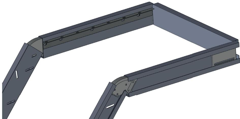
Montieren Sie die Innenwinkel für das Gitterrostpodest. Wenn nötig müssen Sie bohren damit die Innenwinkel mit den Wangen verschraubt werden können.
